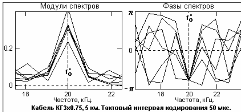
Рис. 16.2.3. Спектры кодов после амплитудного детектора.
