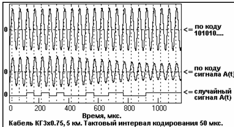
Рис. 16.2.4. Сигнал на выходе СФ на частоте f''_0 .
