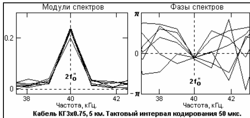
Рис. 16.2.6. Спектры кодов после амплитудного детектора.
