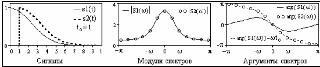
Рис. 4.3.3. Изменение спектра сигнала при его сдвиге.
